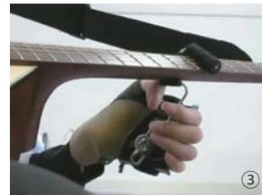
握力がない方でも、肘や肩の動きと自助具のてこのしくみを利用することで、弦の押さえと開放が可能になります。 ③弦の押さえ操作と④弦の開放操作
